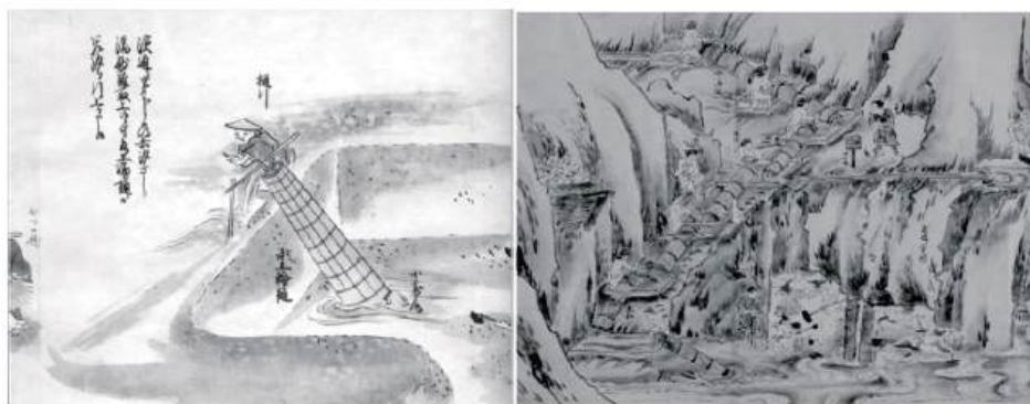
Fig. 13. Dibujos obtenidos de Rollos de Minería de Oro en la Isla Sado en Japón. Izquierda: Tornillo de Arquímedes único (Winkelmann, 1964). Derecha: Tornillo de Arquímedes séptuple (National Archives of Japan Digital Archive).
